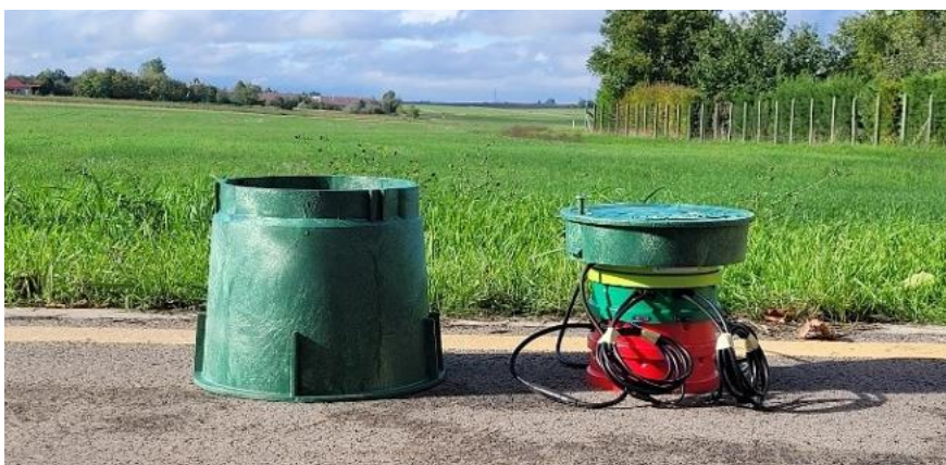
32. ábra: Kerékpárút burkolatába frissen telepített indukciós hurok és a föld alatt elrejtett elektronika (forrás: Eco-Counter)
